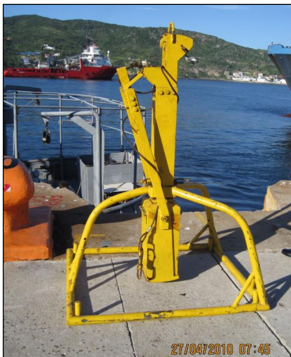
Figura 9. Coletor de sedimento do tipo box-corer utilizado na coleta dos testemunhos na plataforma continental de Cabo Frio.
